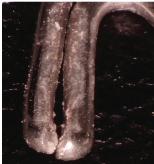
FIGURA 3. Zona de Fractura del QH
