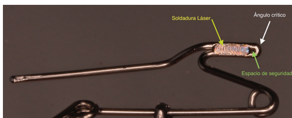
FIGURA 4. Diseño del QH y soldadura láser
